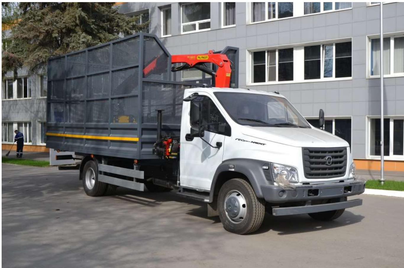
Бортовой автомобиль с металлическим каркасом со стальной сеткой и КМУ PALFINGER РК 6500 с грейфером. В качестве шасси выбран Газон Next 10 тонн. Автомобиль оснащен бортовой платформой с сетчатым кузовом под легковесный груз (5000x2540x2665мм). Снаряженная масса автомобиля - 5600 кг, при полной массе Газон Next 10 000 кг масса перевозимого груза составит 4 400 кг.
